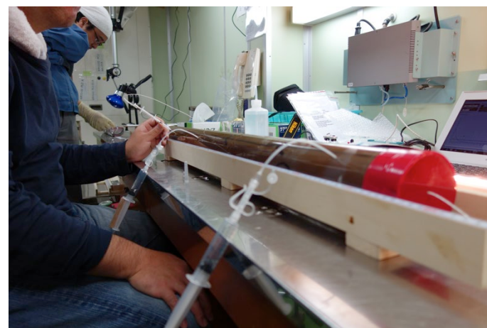
レアアース泥試料からの間隙水の抽出と酸素濃度測定(深海調査研究船「かいれい」船内実験室)
